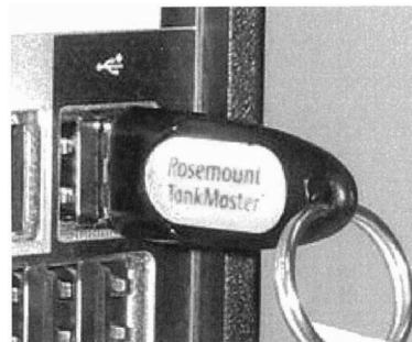
Esquema de selagem do software Tankmaster Imobilizando o dispositivo na respectiva porta
