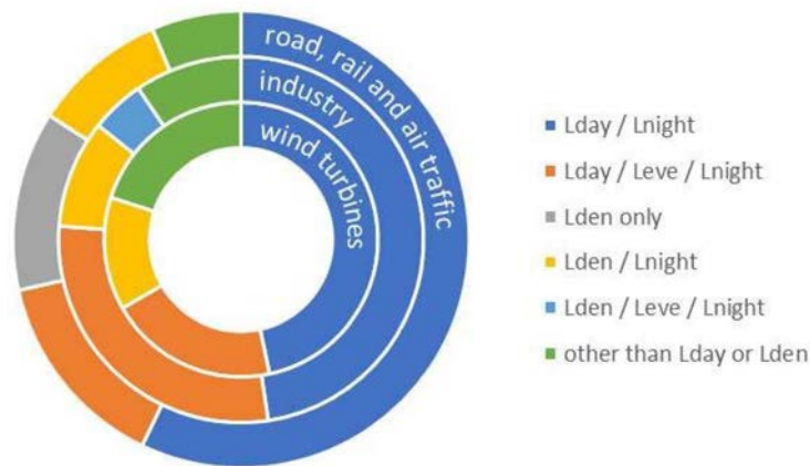
Figura 9 – Indicadores utilizados pelos diferentes países europeus na definição de limites por tipo de fonte de ruído (IGNA, 2019)
